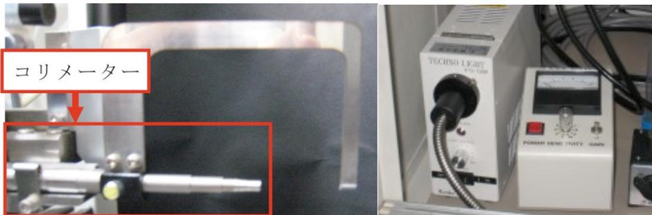
4: パソコン上で、CCD を選択すると、X-ray 照射位置が映像で出てくるので、図 4 の高さ調整ネジを使って、まず試料の高さを設定する。
