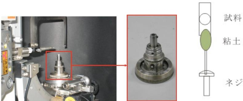
図 2 試料台の設置位置と取り外し時画像
