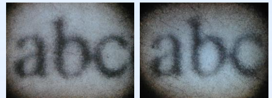
1 [mm] F_{N_2}=0.5\% 1 [mm] F_{N_2}=1.0\% 本研究室で人工合成したダイヤモンド膜
