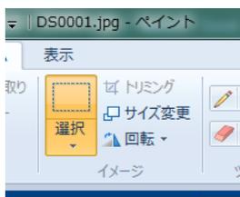
(3) ペイントソフトのメニューに[選択]というアイコンがあります。これをクリックしてグラフ表示エリアのマス目の幅を測るようにクリック&ドラッグします。図ではグラフエリアの[5マス]分の幅を計測しています。左下に選択領域の幅が表示されています。ここでは375ピクセルと表示されています。5マス分、つまり2.5秒(2500ミリ秒)が375ピクセルです
