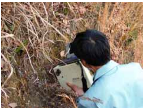
図-3 近赤外線スペクトロメータによる現場測定状況
