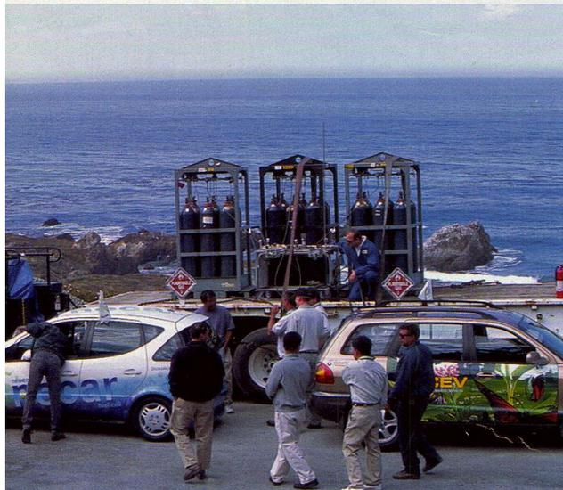
クルマの向こうに見えるのが、水素供給用の圧縮ボンベ。この量で4台程度を満タンにでき、すっきりとしたトヨタFCHV-4のエンジンルーム。燃料電池ユニットが入っている
