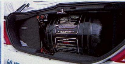
フォード・フォーカスFCVのトランクルームを占める圧縮水素タンク。178ℓのタンクに350気圧で水素を貯めると、1充填で約320km走ることができる
