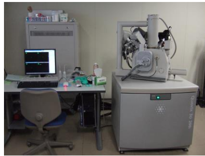
集束イオンビーム加工観察(FIB) FIB+SEM: デュアルビーム(DB) FIB: Gaイオンビーム Pt-deposition: 保護層形成 極細探針: 極微試料採取
