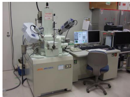
電界放射型走査電子顕微鏡(FESEM) FESEM: 表面微細構造観察+各種分析 EDX & WDX: 元素分布分析 EBSD(OIM): 結晶方位分布・ひずみ解析 Cathodoluminescence: 電子励起発光
